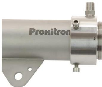
Zum Schutz der Optik vor Verschmutzung können PROXITRON Lichttaster mit einem zusätzlichen Luftblasvorsatz versehen werden. Der empfohlene Betriebsdruck liegt bei 0,15 bar. Dieser Wert entspricht einem Verbrauch von 60 l/min. Der maximale Betriebsdruck liegt bei 0,3 bar. Um eine Verschmutzung der Optik durch Spülluft zu vermeiden, muss diese trocken, öl- und staubfrei sein. Für die optimale Wirkung des Luftblasvorsatzes wird der Einsatz eines zusätzlichen Schutzrohres OL 37 oder OL 38 empfohlen.
